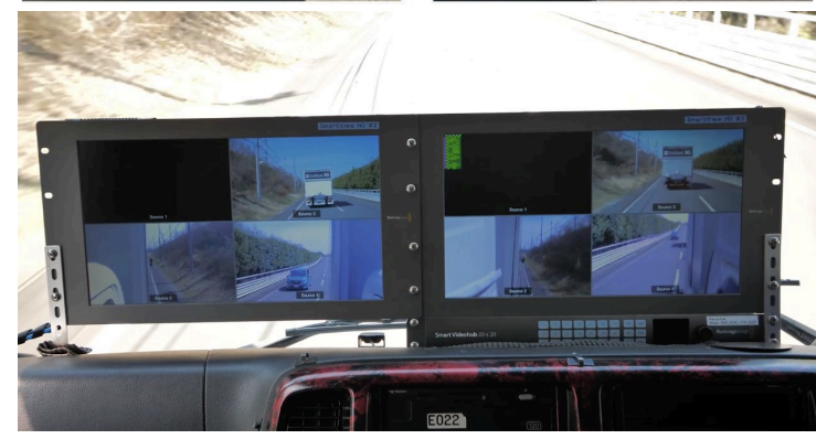
先頭車両の運転席には、2台目以降のカメラ映像が5Gで低遅延伝送され表示される
