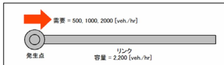
図 1-1 車両発生検証用モデルの説明図
